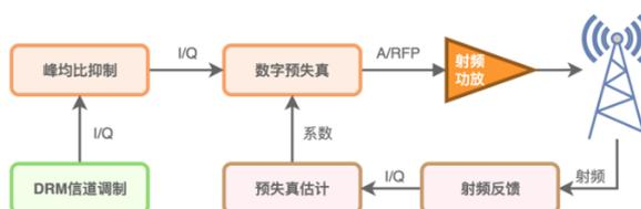
数字基带预失真 (DPD) 是实现大功率中短波发射机数字化的关键技术。
