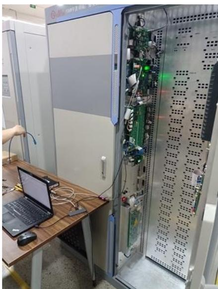
DX 中波发射机改造，载波功率 10kW，DRM 输出功率 4.5kW，ACPR>40dB。
